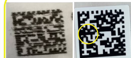
Смазывание кода маркировки или его отдельных элементов
