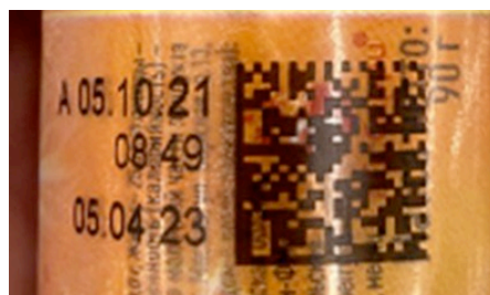
Печать кода маркировки на бликующей/светоотражающей поверхности
