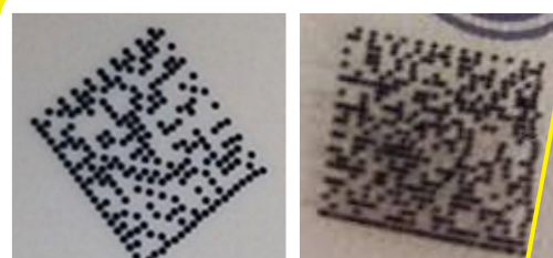
Нарушение геометрии кода маркировки (модуляция)
