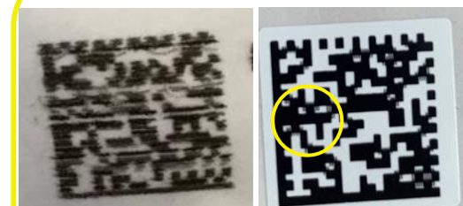
Смазывание кода маркировки или его отдельных элементов
