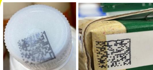
Смещение кода маркировки при печати
