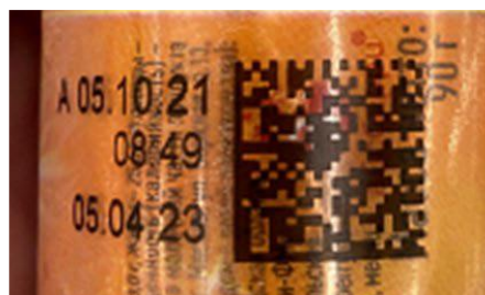
Печать кода маркировки на бликующей/светоотражающей поверхности
