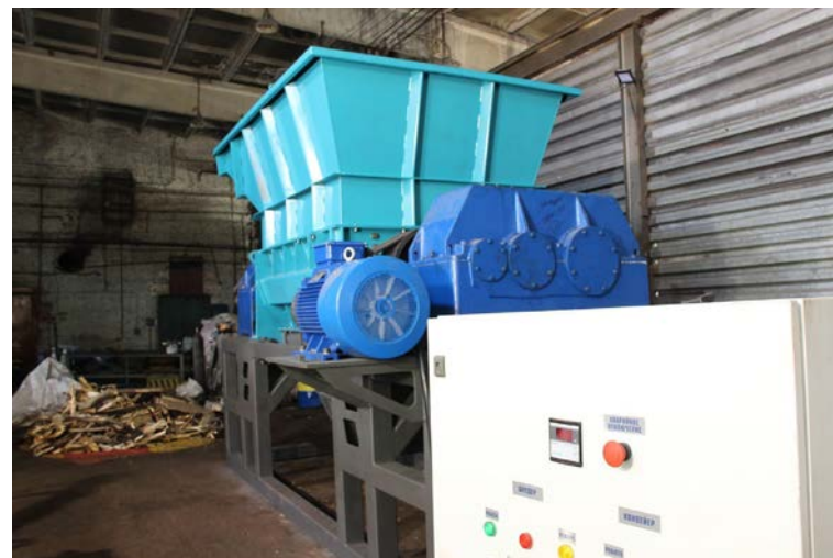
Двухвальный шредер мощностью до 270 кВт.
