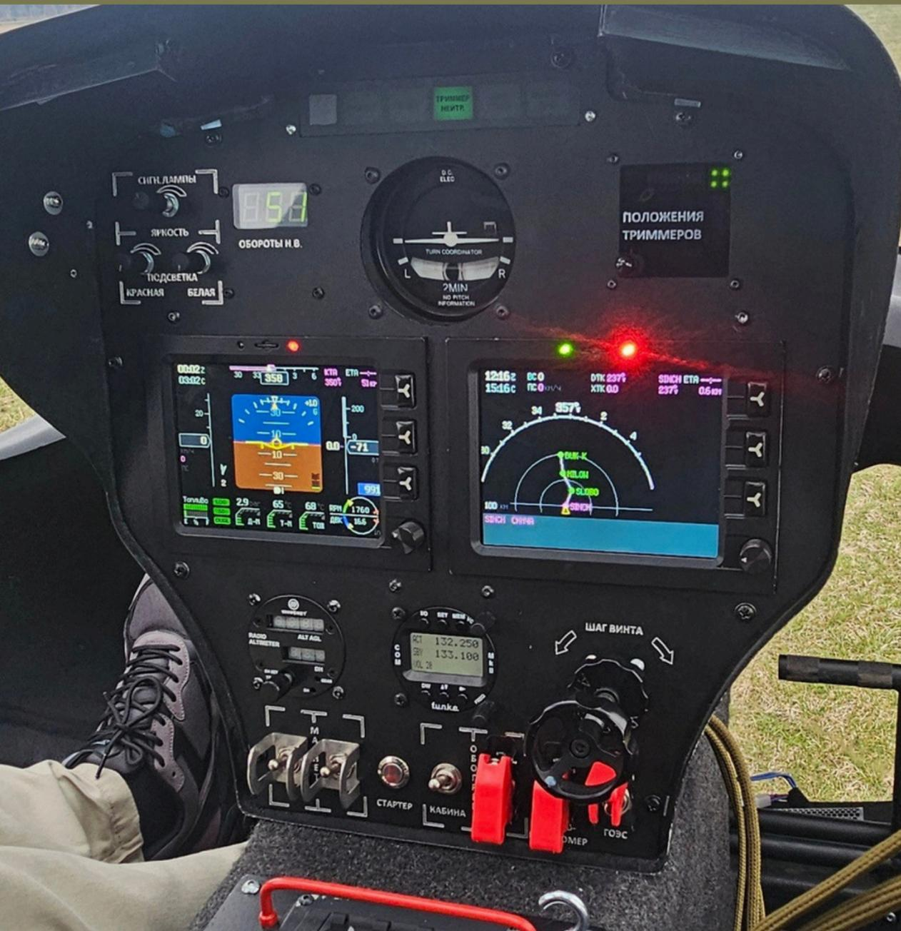
1. **Светосигнальное табло:** Индикация пожара двигателя, отказа генератора и дополнительного генератора, нейтрального положения триммеров, обогрева ПВД.
